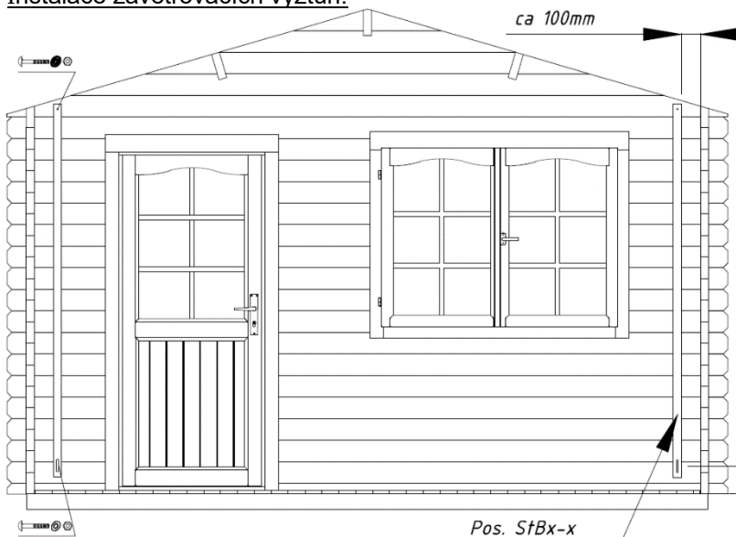
Instalace zavětrovacích výztuh:
